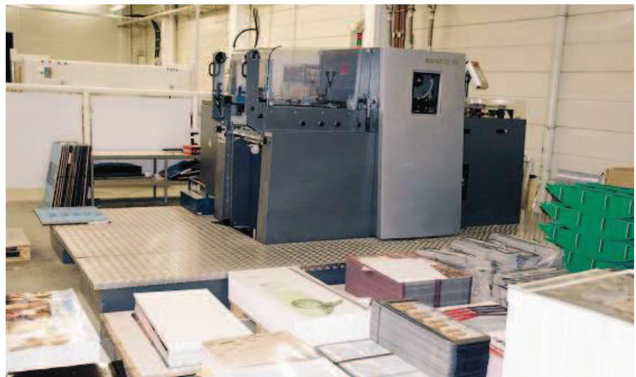
**Leistungsstark mit bis zu 5.000 Bogen/h und mit dem Hot-Cut-System zum Heiß-Stanzen von Plastik und Folien ausgestattet: die Kama TS 74 bei Ricken.**
